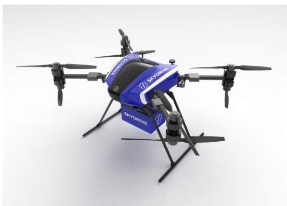
今回使用した重量物運搬ドローン
