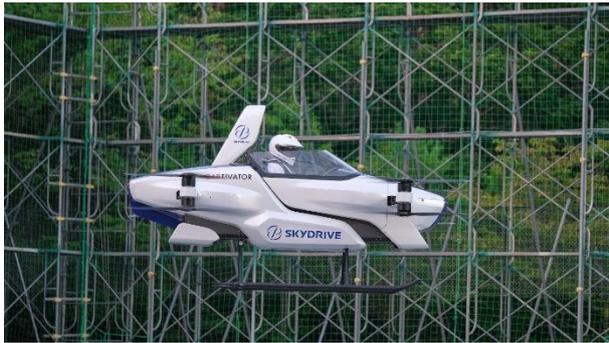
「空飛ぶクルマ」 有人飛行試作機「SD-03」
