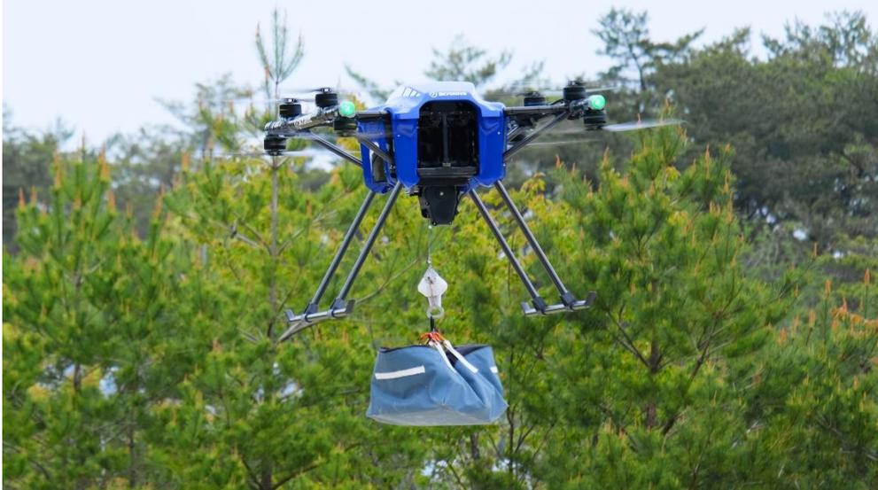
最大30kgの荷物を運搬、着陸せずに荷下ろしするホイスト機構を搭載可能
