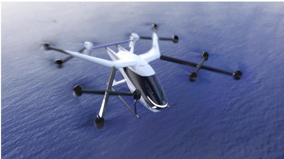
機体は、鳥や動物のストリームラインを研究し設計した先進的な空力形状で、飛行をより安定させるために水平と垂直の尾翼を設置しています。機体の上部には、12基のモータとプロペラが配置されており、当社がこれまでの機体開発プロセスで行った、1,000回以上の飛行テストにて培った制御技術により、安定した飛行を実現しています。
