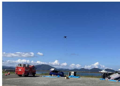
ホイスト機能を活用し ホバリング状態での荷下ろしの様子
