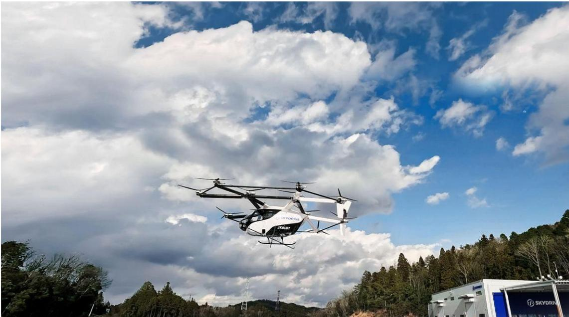
SKYDRIVE（SD-05 型）の飛行試験の様子
